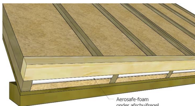
Figuur 4 - Aerosafe-foam onder afschuifregel
