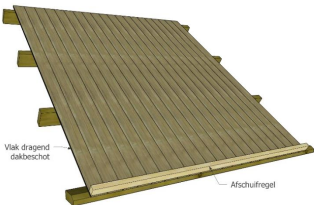
Figuur 3 - Afschuifregel op vlak dragend dakbeschoot
